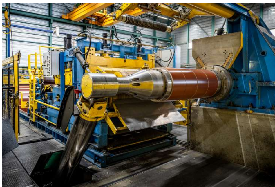
2 Spaltanlagen für exakte Längsteilungen von Coils zu Spaltband
