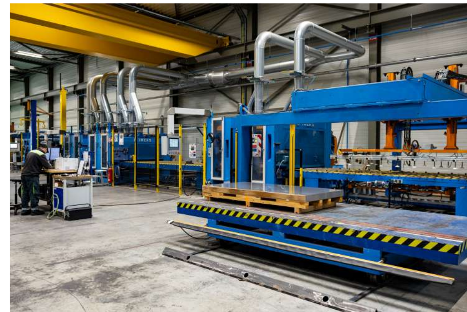
5 Schleiflinien zur Bearbeitung von Edelstahl
